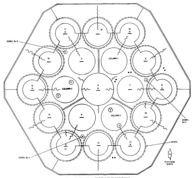
PLAN OF HEXAGONAL FOUNDATION SLAB SHOWING THE FOUNDATION DRAINAGE SYSTEM AND INSTRUMENT LOCATION
